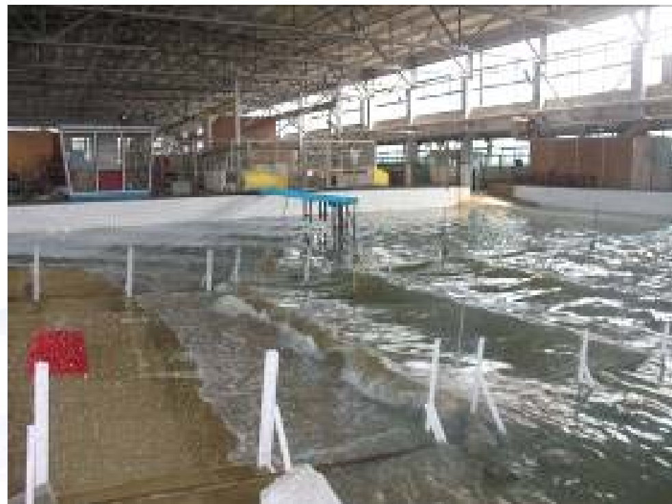
Рис.10. Накат поверхностных волн в экспериментальном бассейне МГСУ (30x30x1,1м) [Кантаржи, 2011]
