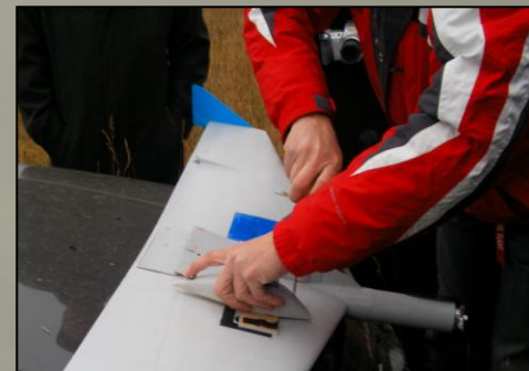
3 Место установки блока тепловизора на БПЛА
